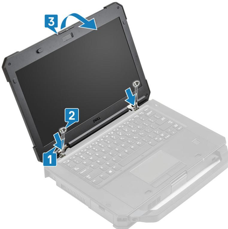
3. Pasang dua sekrup epoksi 'M2\*3' yang menahan engsel ke unit dasar [1] dan kabel antena yang diulir kembali [2].
