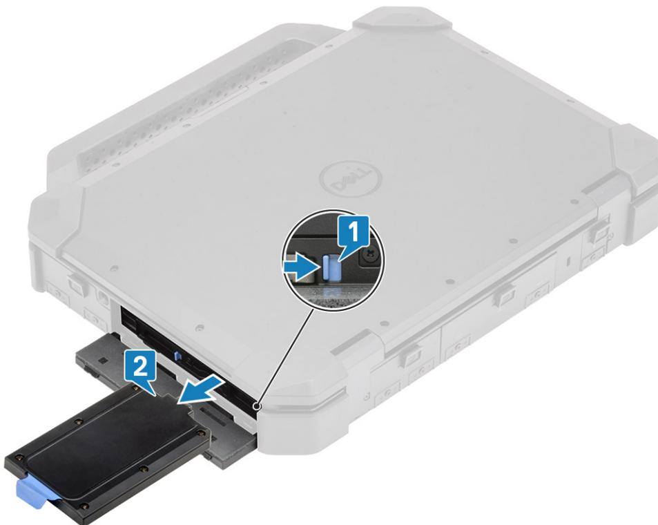
4. **i** **CATATAN:** Tergantung pada konfigurasi yang dipesan sistem mungkin memiliki Hard Disk atau Solid State Drive di dalam pembawa. Prosedur pemasangan dan pelepasan tetap sama.
