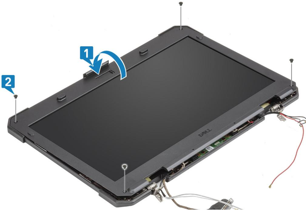
5. Pasang 12 sekrup 'M2.5' untuk menahan penutup belakang ke LCD dengan unit bezel.
